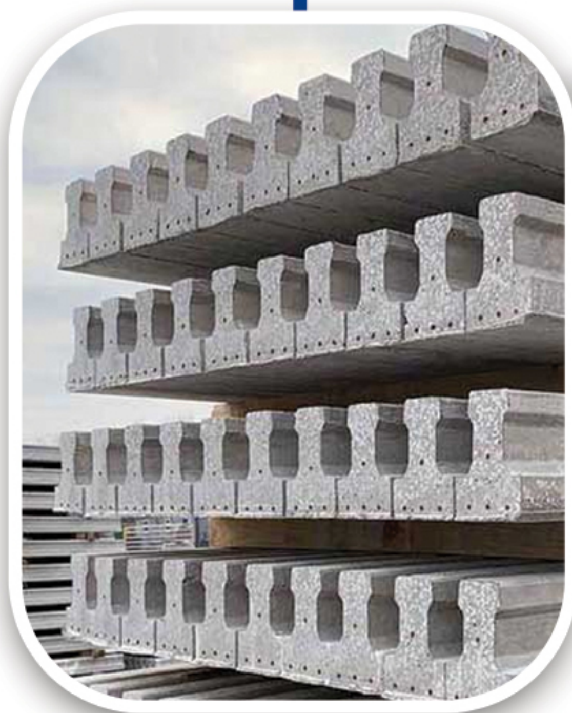
راه اندازی خط تیرچه پیش تنیده شرکت بنیاد بتن جنوب شرق
