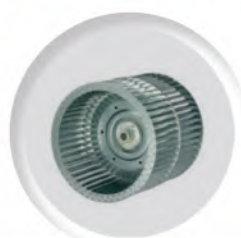
پروانه فوروارد دو طرف ورودی با تیغه های مولتی بلید مناسب برای فشار پایین و دبی بالا
