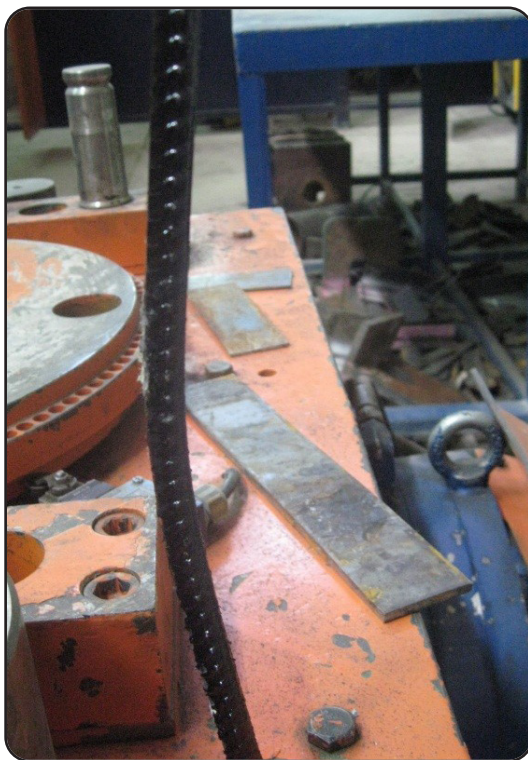
میلگرد دارای اندود موم پرایمر پس از اتمام بازخم که فاقد هرگونه ترک و پلیسه است
