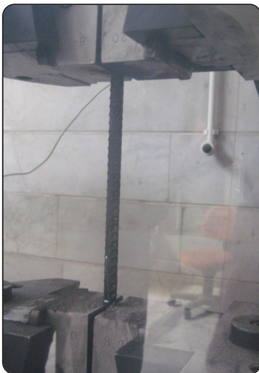
میلگرد دارای اندود عایق موم پرایمر تحت نیروی کشش تا لحظه گسیختگی میلگرد، هیچگونه ترک کششی یا پلیسه شدگی در عایق ایجاد نشد.
